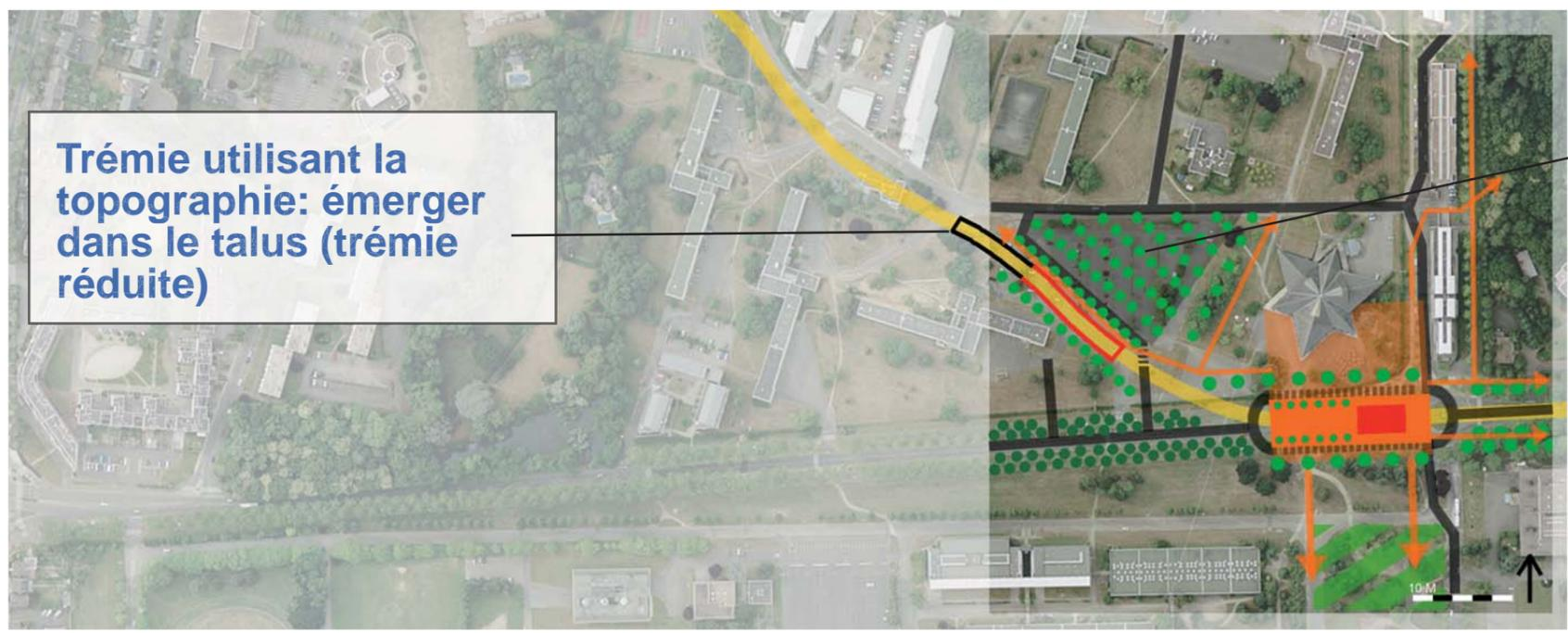
Trémie utilisant la topographie: émerger dans le talus (trémie réduite)
