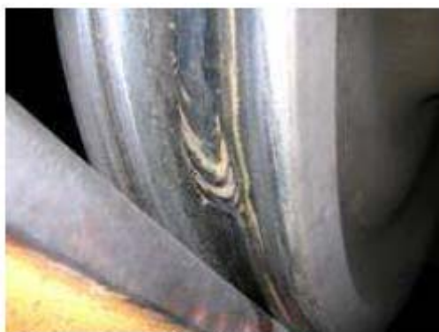
Une roue abîmée par l'enrayage
