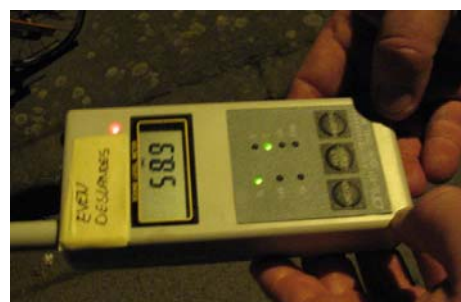
Figure 13 - Relevé du bruit de fond de la station Pontchaillou à 110m
