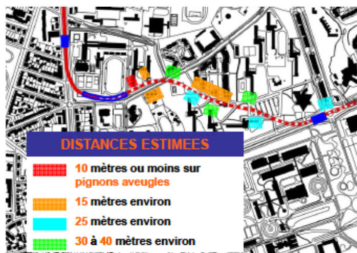
Figure 18 - Distance du viaduc par rapport aux habitations dans le cadre du projet Transporteur
